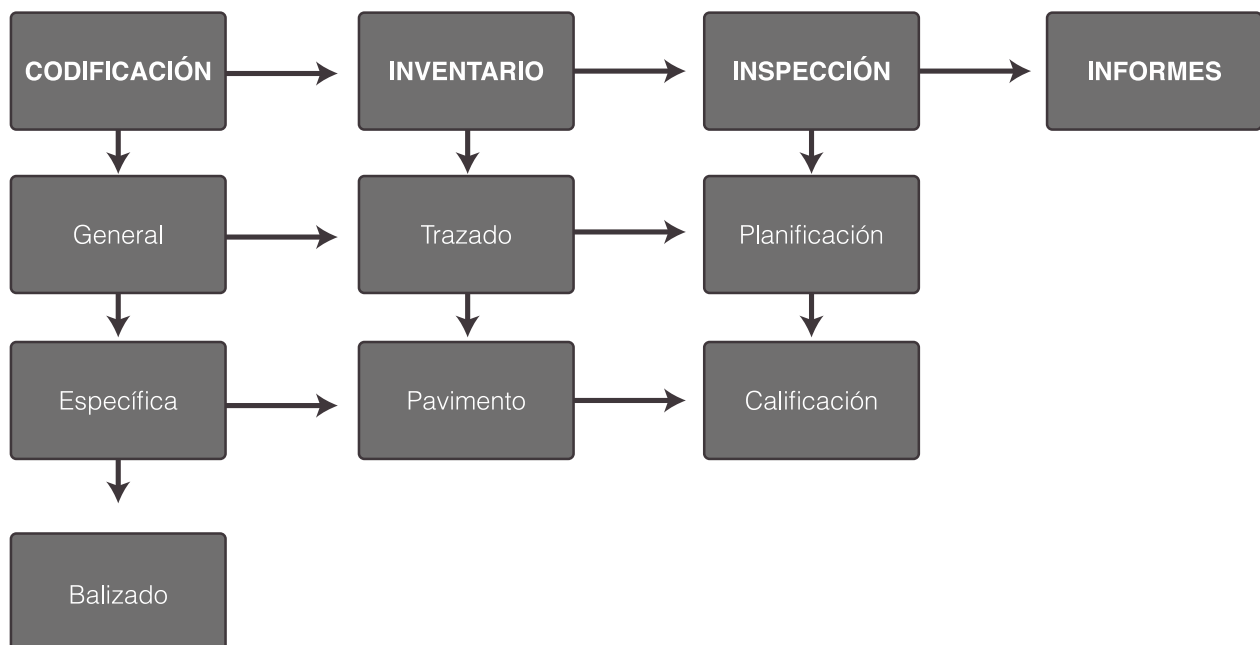
Figura 6.1 Diagrama general de un proceso de inspección visual (Echaveguren et al., 2002).
