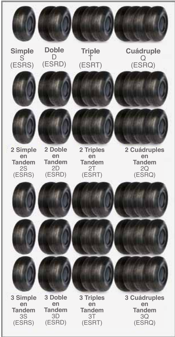
Figura 4.7 Configuraciones genéricas de rueda en aeronaves (FAA, 2009).
